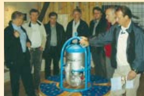
I Flygts eget museum kan vi se "Papegøeyeburet", den første senkbare lensepumpen som var begynnelsen på industrieventyret.
