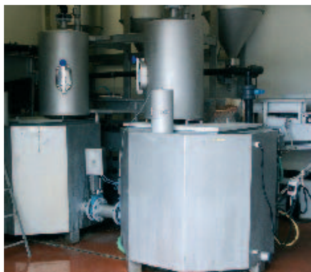
Det tilsettes maursyre i ensileringstanken i produksjonen av ensilering.
